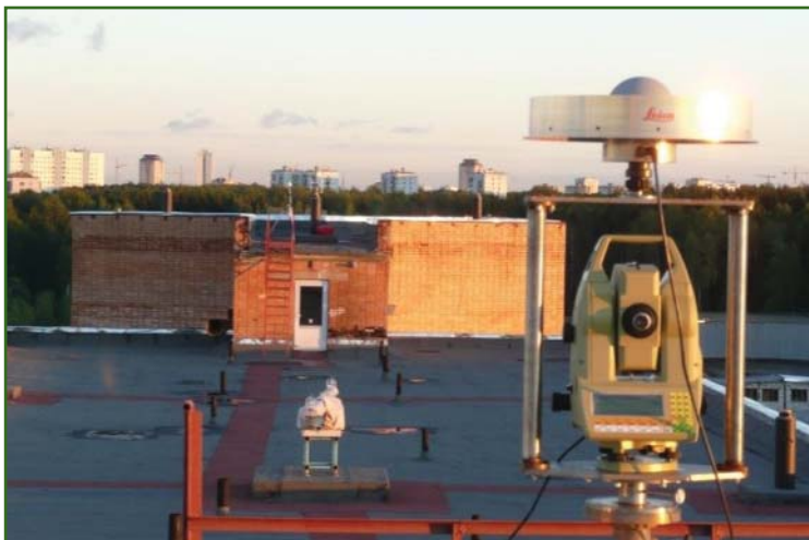
Рис. 2 Электронный тахеометр, входящий в состав лазерного эталона сравнения и эталонных базисов в диапазоне 24–3000 м
