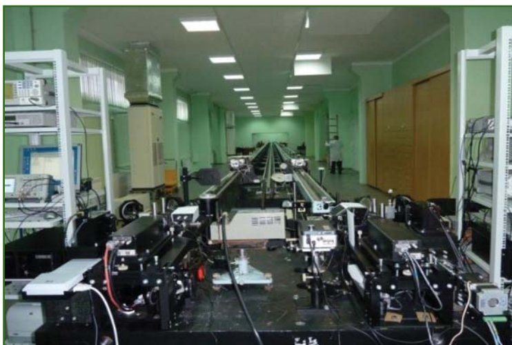
Рис. 1 Эталонный измерительный комплекс длины до 60 м
