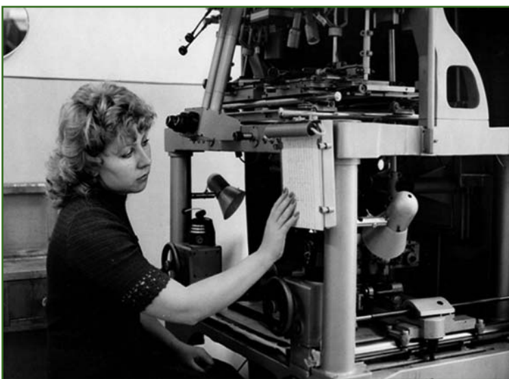
Работы по сгущению планово-высотных геодезических сетей на приборе СПР-3
