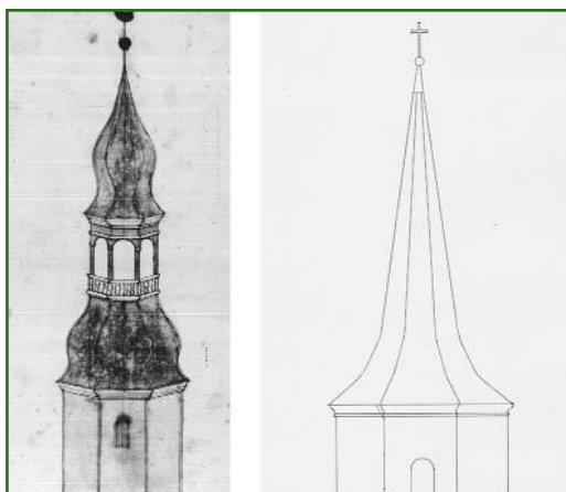
Рис. 2 Шпиль купола башни звонницы церкви Святого Маврикия: 1767 г. (слева); 1865 г. (справа)
